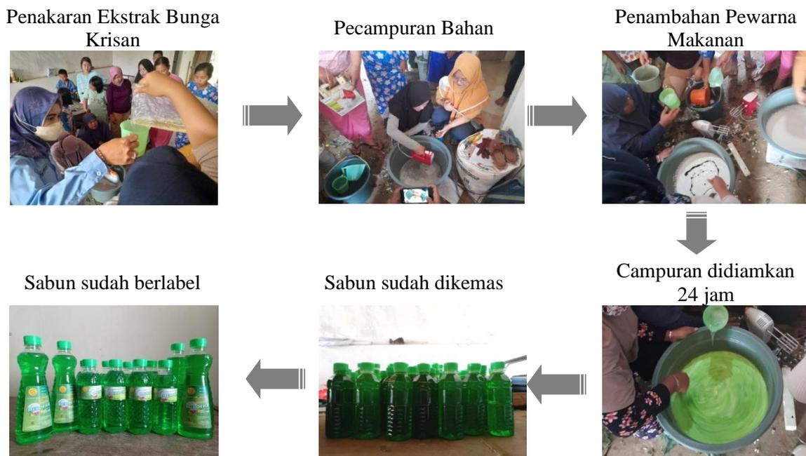
Figur 3. Tahapan Pembuatan Sabun Cair dengan Tambahkan Ekstrak Bunga Krisan
