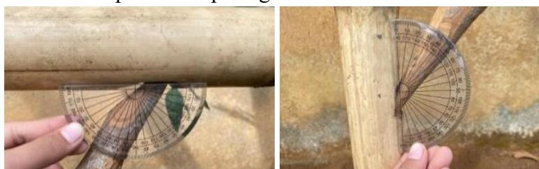
**Gambar 11.** Pengukuran sudut lancip pada pijakan ingkau
