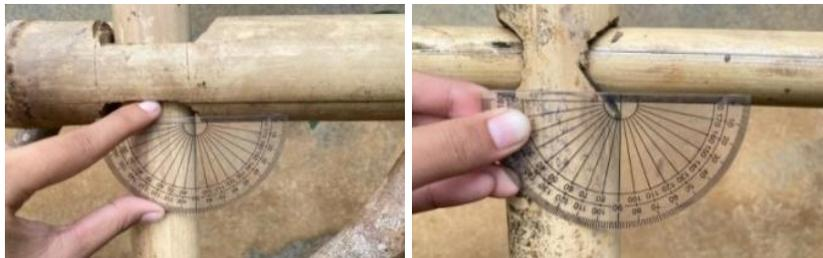
**Gambar 8.** Pengukuran sudut siku-siku pada pijakan ingkau
