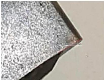
Gambar 4. 2 hasil pengukuran keausan pahat B dengan tebal pemakanan 1 mm
