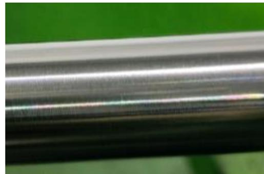
Gambar 4. 8 hasil proses pembubutan dengan tebal pemakanan 1 mm
