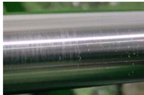
Gambar 4. 9 hasil proses pembubutan dengan tebal pemakanan 1,5 mm
