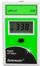
Pengukuran radiasi UV-B yang bersumber dari proses pengelasan dilakukan dengan mengukur langsung pada saat proses las berjalan pada posisi dekat dengan mata pekerja las, dengan asumsi bahwa besarnya radiasi yang diterima oleh mata pekerja las sama dengan besarnya radiasi hasil pengukuran dengan alat *Solarmeter*. Pengukuran radiasi dilakukan pada saat bekerja pada pukul 10:00 – 11:00 WIB yang mana proses produksi sangat tinggi.
