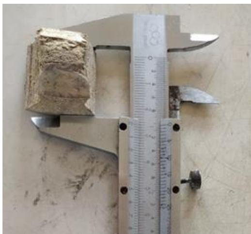
**Gambar 2.** Ukuran Sampel Pengujian Sifat Fisik Bambu
