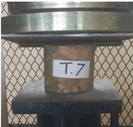
**Gambar 7.** Pengujian kuat tumpu
