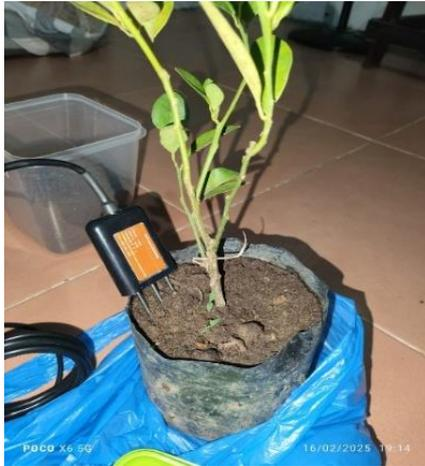
Gambar 13. Pengujian Sensor NPK
