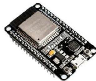
Gambar 1. Mikrokontroler ESP32
