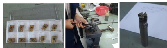
Gambar 2. Persiapan dan pemasangan insert carbide cutter
