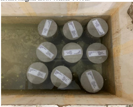
Gambar 8 Perawatan Beton Pada Bak Air
